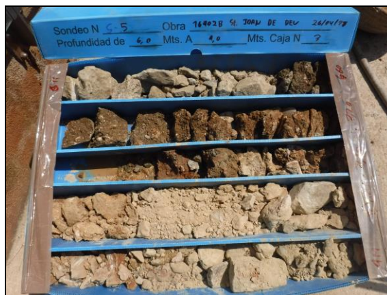
Detall de la caixa al S-5, terres de replè.
